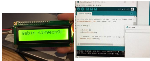
그림 3 (좌) LCD 단독 구동 성공, (우) IDE 시리얼 모니터에서 확인한 SGP30 센서 출력값
